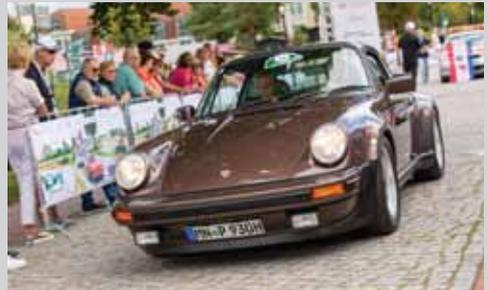
Nachdem 1973 das G-Modell den Ur-Elfer abgelöst hatte, entschied Porsche, die für einen neuen GT-Renner gewonnenen Erkenntnisse in einen Straßensportwagen zu übersetzen. Gegenüber dem früheren Topmodell Carrera 2.7 wuchs die Breite zur Unterbringung 225 Millimeter breiter Reifen um 50 Millimeter. Den Auftrieb reduzierten ein Frontspoiler und ein großer Heckflügel, der schon 1973 bei der Rennversion des Carrera den Entenbürzel abgelöst hatte. Die „Walflös-
